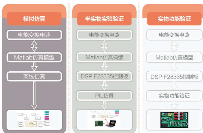
基于模型设计开发流程
